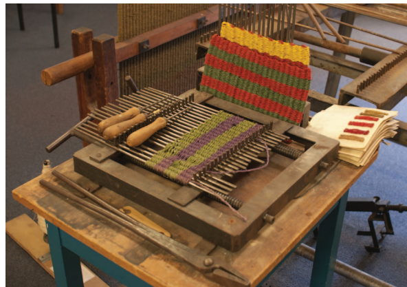
Arbeidstherapie nam een belangrijke plaats in. Hier is een mattenvlechtapparaat te zien.
